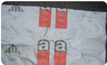
Sac à déchets amiantés
